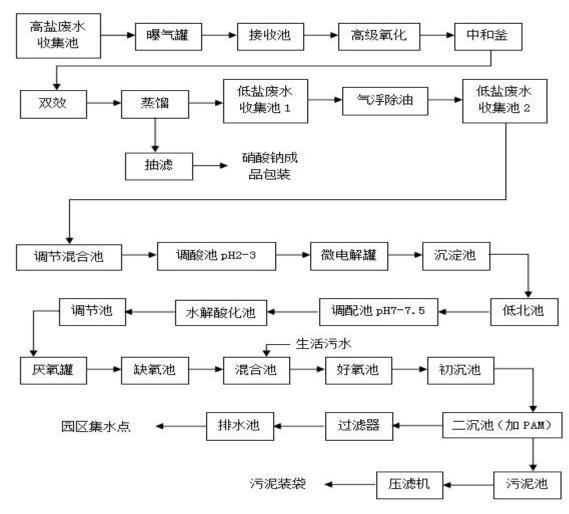
图 4-1 废水处理工艺流程
