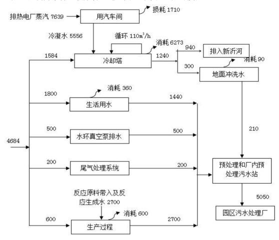
图 3-5 项目水平衡图 (t/a)
