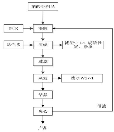
图 3-2 工业硝酸钠工艺流程及产污环节
