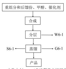
图 3-1 光稳定剂 900 工艺流程及产污环节
